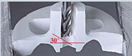
Pour fraiser un siège de vis présentant une conicité de 30° par rapport à la vis.
