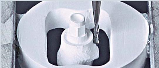
Pour réaliser l'extrados du pilier implantaire en utilisant le palpeur frictionnel 1 L F+, ce qui permet de faire en sorte que le bord reste un peu plus grand.
