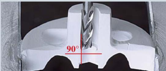
Pour réaliser un puits de vissage à 90°.
