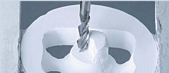
Pour fraiser les faces parallèles des piliers implantaires, des attachements, des barres fraisées à 0°, ainsi que les sièges et puits des vis.
