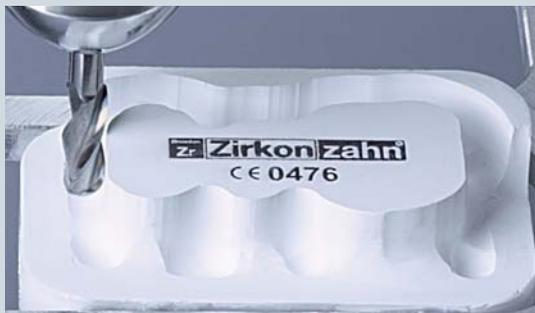
Pour le fraisage de la zircone crue (ébauchage / dégrossissage).
